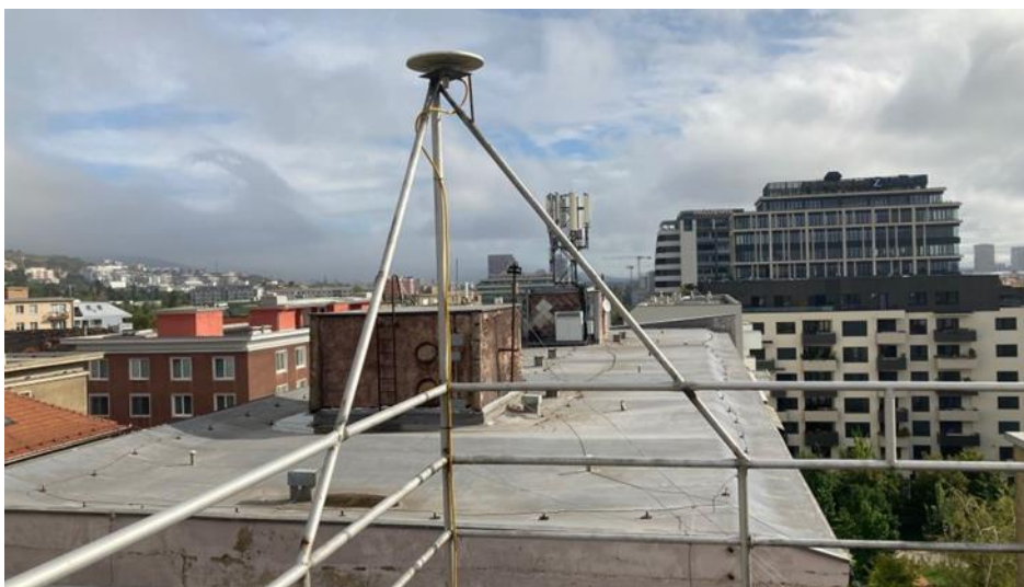
Nová monitorovacia stanica SKPOS ® na Astronomicko-geodetickom observatóriu KGGG s označením AGOA
