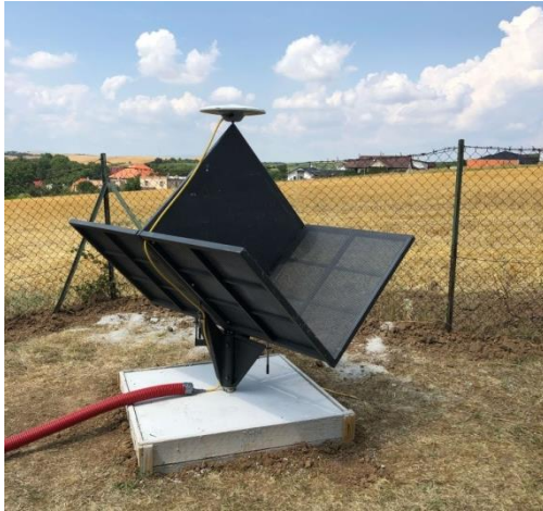
obr. 1 Anténa osadená na kútovom odrážači pre InSAR (vľavo), umiestnená v lokalite hviezdárne v Partizánskom pri SKPOS stanici PEMB (vpravo)
