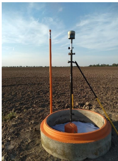
Prestabilizácia a meranie bodu ŠPS →
